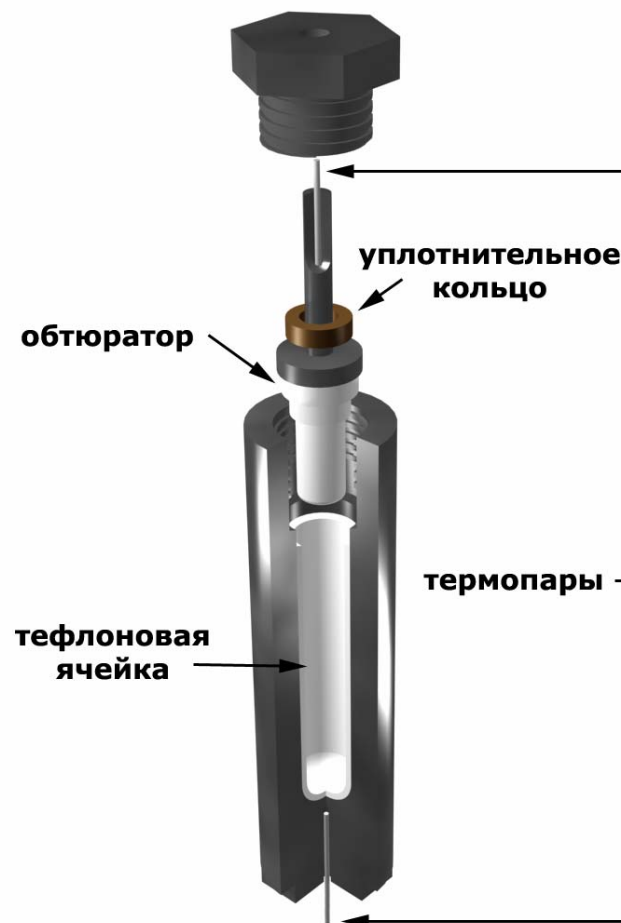
Схема установки для проведения гидротермального синтеза
