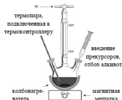
Рис.2. Схема установки для синтеза КТ.
